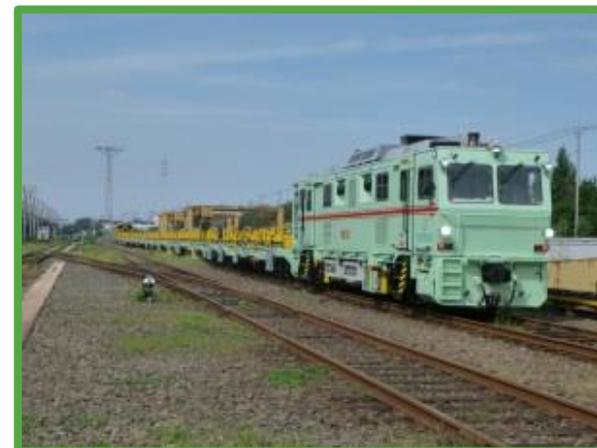
開業から35年が経過し、交換時期を迎えた東北新幹線のレール交換作業に、「**新幹線レール交換システム(通称REXS:Rail EXchange System)**」を導入し、'17年度より本格稼働いたしました。このREXSは、レール交換の主な作業であるレールの運搬・積みおろし・溶接・交換を種々の大型機械を組み合わせる一つのシステムとして行うことができる世界初の保守用車となります。
